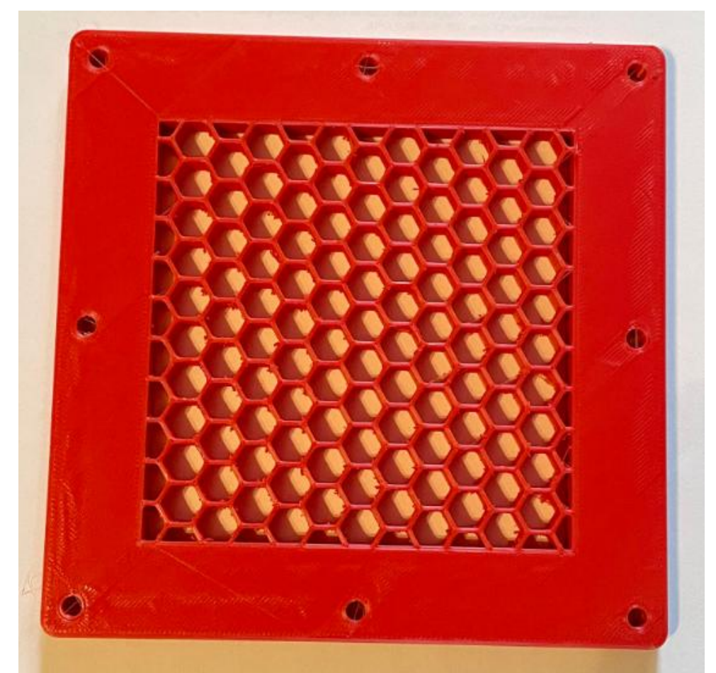
Zdjęcie samodzielnej sekcji z wbudowaną heksagonalną ulownicą
