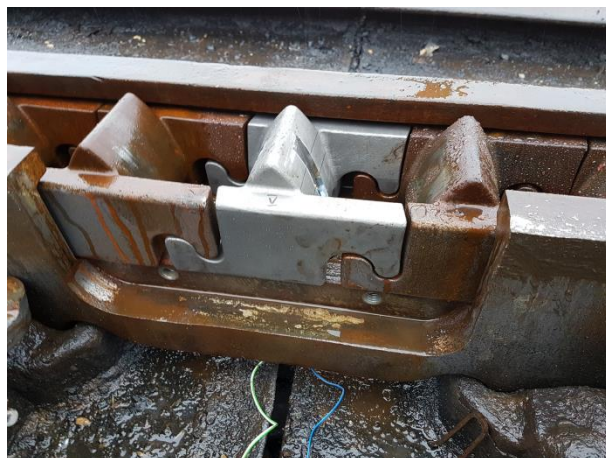
Rys. 7. Badania stanowiskowe nowej generacji system posuwu wysokowydajnych kompleksów ścianowych – KOMTRACK
