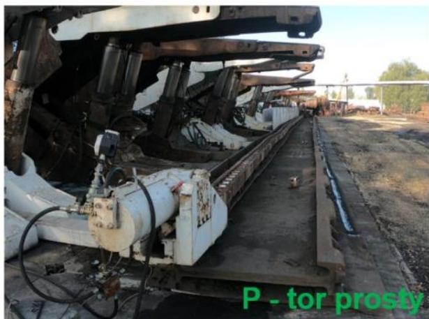
Rys. 7. Badania stanowiskowe nowej generacji system posuwu wysokowydajnych kompleksów ścianowych – KOMTRACK
