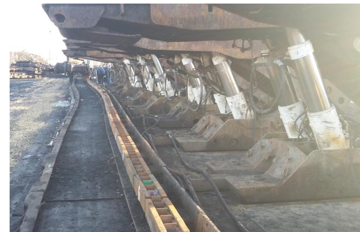
Rys. 7. Badania stanowiskowe nowej generacji system posuwu wysokowydajnych kompleksów ścianowych – KOMTRACK
