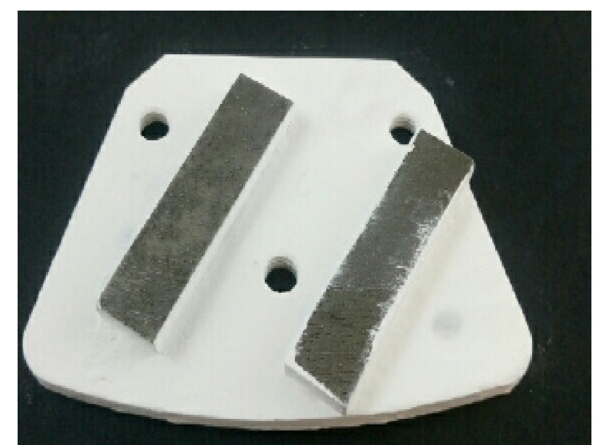
Rys. 6. Przykładowe narzędzie metaliczno-diaamentowe do obróbki powierzchni betonowych i kamiennych
