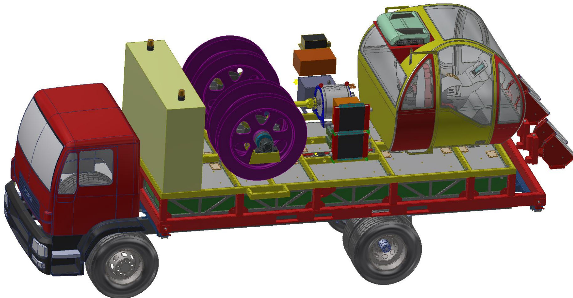
Rys. 1 Innowacyjne rozwiązanie wyciągarki szybowcowej z elektrycznym układem napędowym zasilanym z baterii ogniwo litowych
