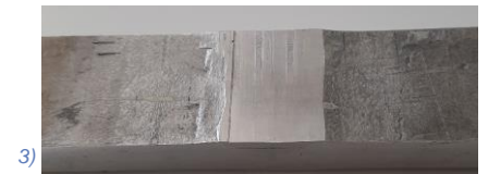
Rys. Obróbka spoiny czołowej przy użyciu proponowanego sposobu i narzędzia: 1) stal konstrukcyjna niestopowa; 2) stal nierdzewna 1.3964; 3) stop aluminium PA47 (7020).
