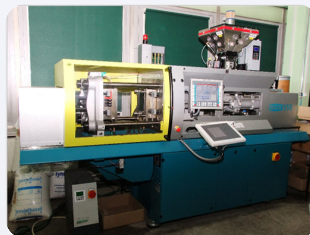
Wtryskarka DrBoy 55E użyta w przetwórstwie biokompozytu
